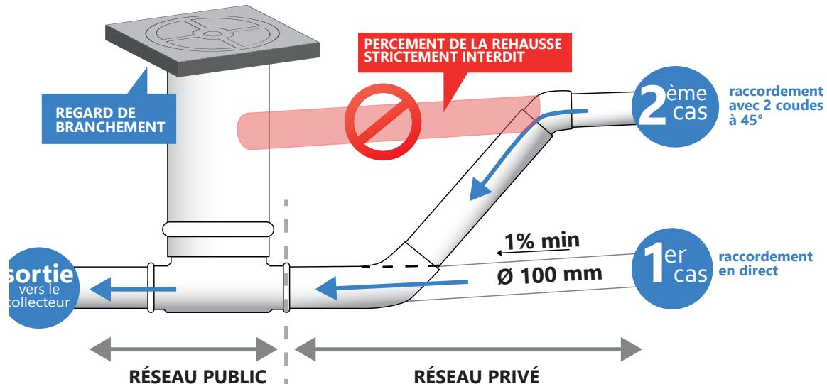
Conformément au règlement d'assainissement collectif, le raccordement sur le regard de branchement devra respecter les prescriptions du schéma ci-dessus.
