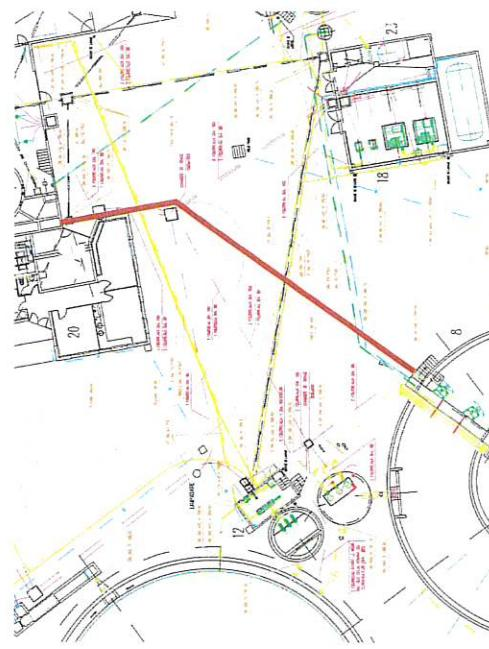
Cette canalisation en acier est enrobée de béton sur la section passant sous le radier du bassin d'aération. Elle débouche dans le puisard de la zone de contact située au centre du bassin d'aération.
