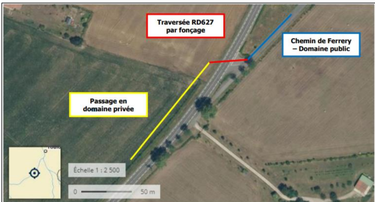
Figure 9 : Fonçage pour traversée RD627
